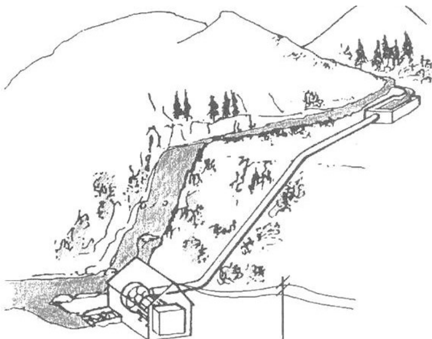
Рисунок 9. Напорная микро ГЭС без деривационного канала
